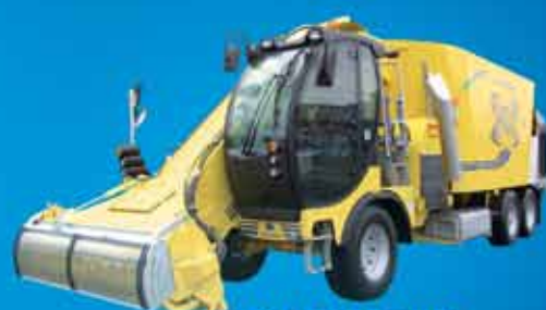
GRIZZLY 8100 eine Schnecke 18-22 m 3 zwei Schnecken 22-35 m 3
